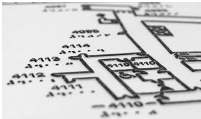
Κατασκευασμένο με μικροκαψουλικό χαρτί μέσω στερεοαντιγραφικής μεθόδου.
